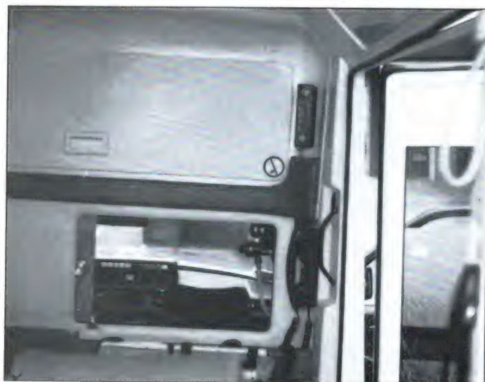
Alle mobilofoons van de Ambulancedienst Regio Utrecht zijn voorzien van een dubbele bediening. Indien nodig kan de verpleegkundige naast de patiënt blijven zitten en direct via de mobilofoon contact opnemen met de CPA.
